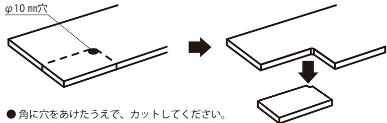
● 切り欠き部が大きい場合や、ピン角でカットした場合、クラックが出る恐れがありますので、複数枚を使用した割り付けとしてください。
